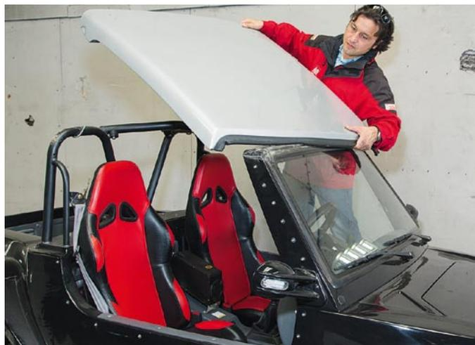
**Acht Schrauben lösen, und das aufpreispflichtige Hardtop (499 Euro) lässt sich demontieren. Das dauert fünf bis zehn Minuten**
