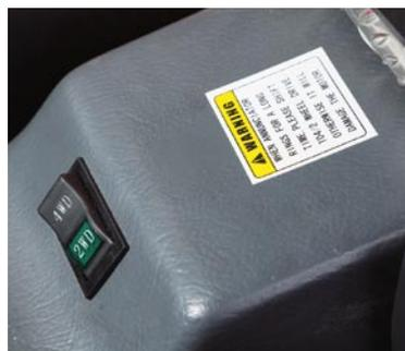
**Oben: Heckantrieb, Frontantrieb per Tastendruck elektrisch zuschaltbar**
